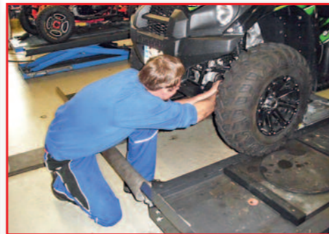
Einstellung bei Sacksteder: mit 1 mm Vorspur
